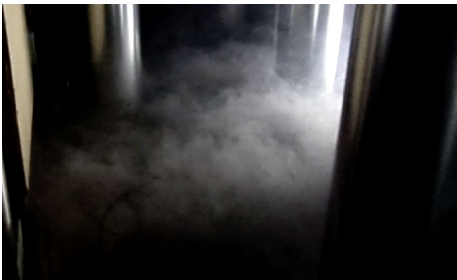
17.3 Luftzuströmung am Luftauslass
