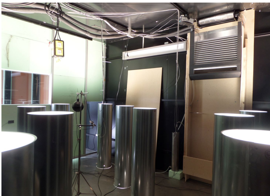
16.3 zweiter Versuchsaufbau im Testlabor mit Ventilator nach DIN EN 442-2
