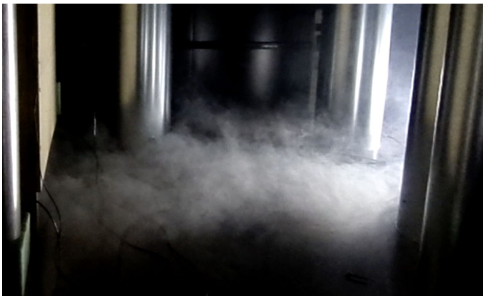
17.2 Luftzuströmung am Luftauslass
